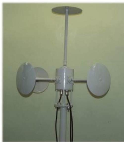
Рис. 19. Активная приемная защищенная антенна (АПЗ) ДКМВ диапазона с триортогональными вибраторами (произв. СОНИИР [35])
