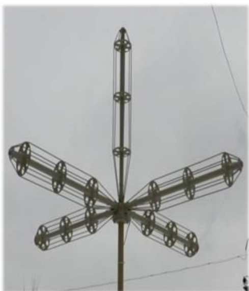
Рис. 18. Активная приемная малогабаритная антенна (АПМ) ДКМВ диапазона с триортогональными вибраторами (произв. СОНИИР [35])
