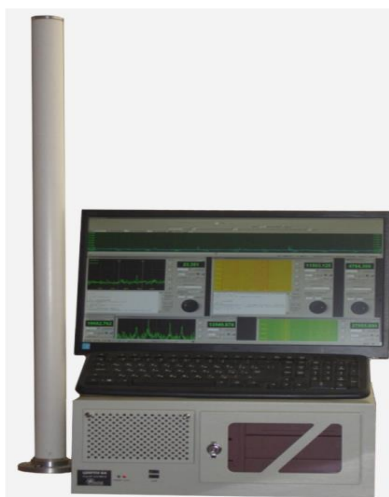
Рис. 24. Широкополосное SDR-радиоприемное устройство с активной антенной, обеспечивающее 64 канала независимого приема
