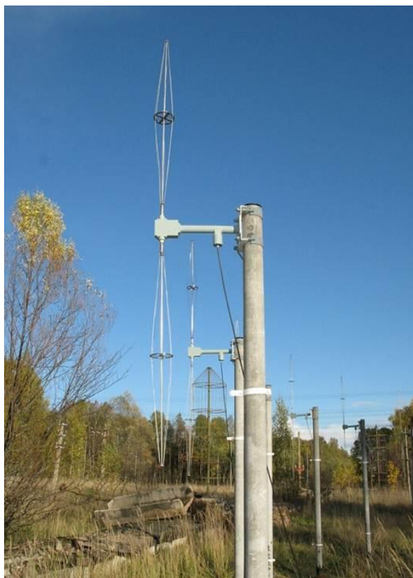
Рис. 23. Быстроразворачиваемая активная кольцевая антенная решетка АКАР (произв. СОНИИР) [35]
